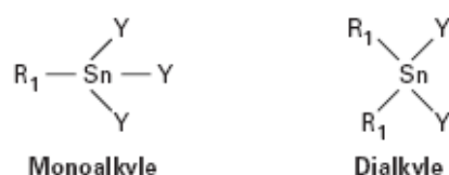
Figure 8: Structure de base d'un stabilisant étain (Girois 2004)
